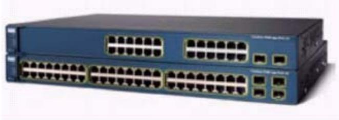
圖 2. Cisco Catalyst 3560 10/100/1000交換器
